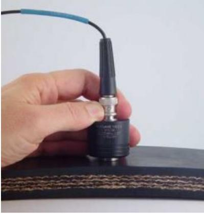
**Applicazione:** Misura della profondità dei rinforzi in tela e acciaio nei nastri trasportatori in gomma e misura dello spessore in gomma residuo dei nastri trasportatori in servizio durante la manutenzione.
